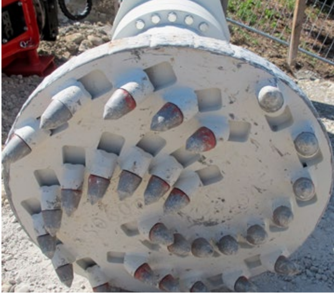
Mit der Frässscheibe wird in einer ersten Phase der Pfahlkopf bis zu den Bewehrungseisen abgetragen (Bild links). Der Innenfräser bricht in einem zweiten Prozessschritt die Kernspannung, der Aussenfräser gleichzeitig die Oberflächenspannung des Betons (Bild rechts).
