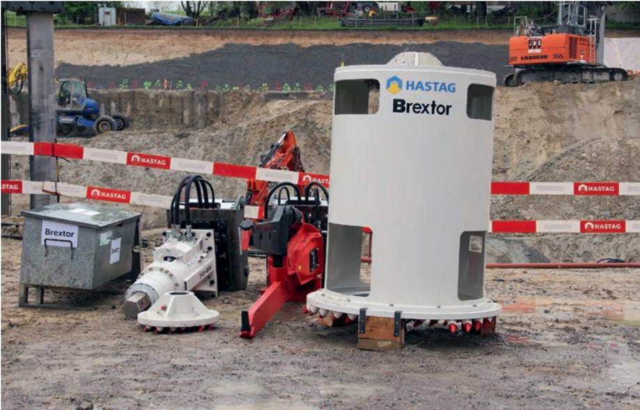
entscheidend und wird auch von den Ingenieuren sehr geschätzt, da Beschädigungen an den Pfahlköpfen durch den BREXTOR faktisch ausgeschlossen sind.
